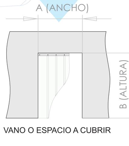
EN CASO DE FIJAR A LA PARED AGREGAR 5cm A LA ALTURA Y 10cm AL ANCHO DE LA MEDIDA DEL VANO.
